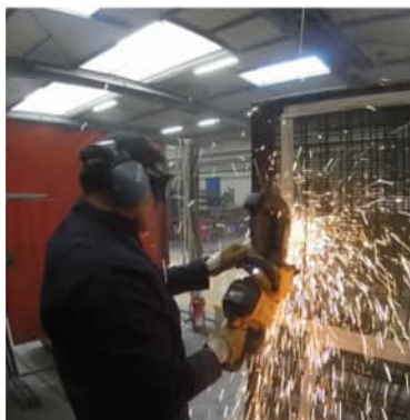
Essais d'effraction menés par la DEND dans le cadre des études sur la protection physique
