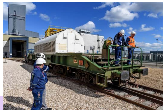
Évacuation d'assemblages combustibles irradiés - ©Laurent Zylberman/IRSN.
